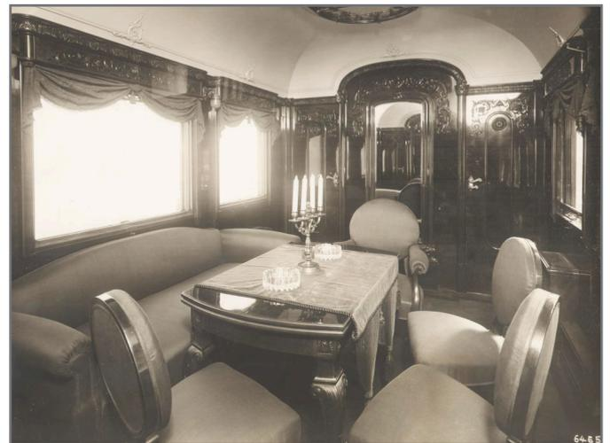
dráhy. Architekt i konstruktéři se navíc museli při realizaci zakázky vypořádat s extrémní délkou vozu 23,5 m, díky níž muselo vzniknout několik modelů ve skutečném měřítku, na kterých pak zkoušeli půdorysné uspořádání. Nakonec bylo vybráno řešení průchozího vozu s postranní chodbou, přerušenou velkým salonem na šířku vozu.
